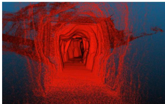
Fig2. 石見銀山の3Dモデルの例。このような3Dモデルを使用して、活断層を含む断層を研究します
