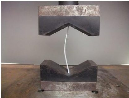
板紙の圧縮曲げ試験
