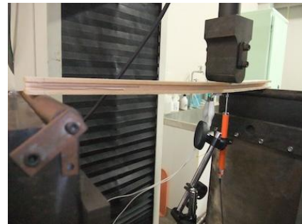
側面に溝を切った木材の 偏心3点曲げ破壊力学試験
