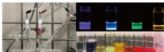
新しい高分子の合成と光学的・電気化学的物性評価および応用に関する研究を行っています。合成した発光性高分子などをを利用して、DNAや金属イオンやpHの高感度センサー、CO<sub>2</sub>電解還元触媒、ナトリウムイオン伝導体の開発を進めています。また、有機低分子が自己組織化して形成されたファイバー状物質に関する研究も行っています。
