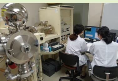
TIMS(表面電離型質量分析計)を用いて 火山岩のSrやNdの同位体比を分析し、そのマグマの起源物質を特定しています。
