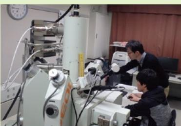
EPMA(電子線マイクロアナライザ)を用いて、岩石中の鉱物等の微小領域(径が数ミクロン程度)の化学組成を分析しています。
