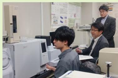
GC-MS(ガスクロマトグラフ質量分析計)やDTA/TG(示差熱・熱重量分析装置)を用いて、岩石中の炭化水素や熱水変質で生成された粘土鉱物などの地下資源の分析を行っています。
